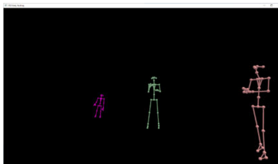
Fig. 3. Posturerkennung in Echtzeit auf Basis des Stereobildes.
